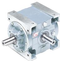
El reenvío de la serie RAN está diseñado para aquellas transmisiones en las que hay que unir dos ejes ortogonales. Fáciles de instalar y casi sin mantenimiento, los reenvíos de la serie RAN ofrecen muchas disposiciones de ejes y con relaciones exactas a partir de 1:1, que son muy útiles cuando se trata de sincronizar un accionamiento. También disponible en la versión para ser utilizado como gato mecánico.
