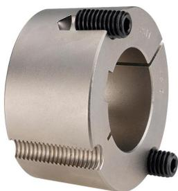
Los casquillos cónicos de fijación son elementos de máquina que establecen una unión, tanto positiva como por adherencia, entre un eje de máquina y un cubo. El eje debe ser cilíndrico y tener una ranura. El cubo debe poseer un agujero de alojamiento cónico con roscas especiales y agujeros de extracción.
