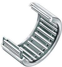
La principal característica que define a los rodamientos de agujas es que están formados por rodillos cilíndricos de un diámetro muy pequeño con respecto a su longitud. Son muy indicados para aplicaciones donde el espacio radialmente es limitado y tienen una elevada capacidad de carga teniendo en cuenta el tamaño de su sección.
