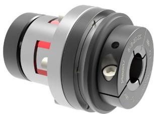
Este acoplamiento de seguridad está equipado con un dispositivo de acople elastómero. Contiene un único par que mide 2-1000 Nm, y un eje que tiene diámetros  $D1 = 8 - 70 \text{ mm}$  /  $D2 = 5 - 70 \text{ mm}$ . Otras especificaciones incluyen un cubo de fijación cónica que es adecuado para diámetros de eje de pequeño tamaño, y un endurecido, se amortiguan las oscilaciones.
