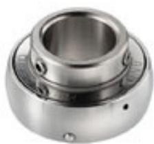
La estructura interna de los rodamientos-insertos de soportes corresponde en gran parte a la de los rodamientos de bolas estándar de las series 6200 y 6300. Sin embargo, presentan anillos interiores más anchos para facilitar la fijación sobre el eje o anillos con taladrados cónicos que permiten utilizar manguitos de apriete. Todos los rodamientos-insertos de soportes son estancos de ambos lados y se pueden suministrar con anillos exteriores cilíndricos o esféricos.
