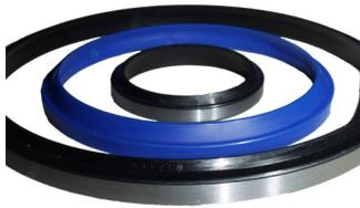
Los rascadores son juntas que evitan la entrada de suciedad, agua, barro, etc. en el interior de los cilindros hidráulicos y neumáticos. Son piezas elastoméricas, con o sin refuerzo metálico, con un labio muy pronunciado, que ejerce una interferencia elevada en el vástago, e impide la entrada de cuerpos extraños..
