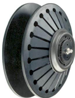
Diseñadas para realizar una variación de velocidad y por tanto de transmisión de fuerza. Las poleas variadoras pueden modificar el ancho de canal, variando así el diámetro de giro de la correa consiguiendo una variación en la velocidad de giro.
