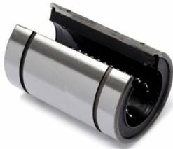
El rodamiento lineal de bolas (llamado también cojinete de bolas o guía de eje) consta de una jaula polimérica con segmentos de camino de rodadura fabricados en acero templado para guiar los conjuntos de bolas dentro del sistema completo. La recirculación de las bolas permite una carrera ilimitada con un movimiento de baja fricción.
