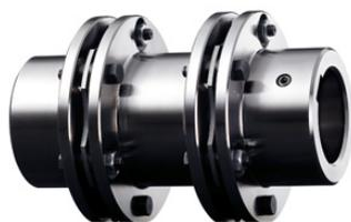
Son acoplamiento de acero sin juego que no requiere mantenimiento. La láminas, extremadamente rígidas frente al sentido del giro, son de muelles de acero inoxidable de alta resistencia y permiten compensar grandes desalineaciones con reducidas fuerzas de reposición. Debido a su diseño enteramente metálico, es posible utilizar el acoplamiento con temperaturas de hasta 280°C.
