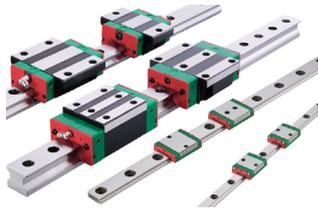
Las Guías lineales proporcionan un tipo de movimiento lineal que utiliza elementos de rodadura de recirculación entre un carril perfilado y un bloque de apoyo. Son capaces de soportar cargas en todas las direcciones y puede lograr una alta precisión y exactitud en movimiento mucho mayor.
