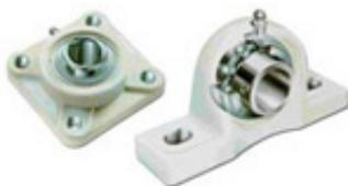
Soportes termoplásticos diseñados para la industria alimenticia, son fabricados con BT (Resina termoplástica reforzada). Estos soportes poseen una excelente resistencia mecánica, rigidez y estabilidad dimensional. Los rodamientos insertos de acero inoxidable son resistentes a la oxidación o corrosión. Soportan temperaturas de  $-35$  a  $102$  °C. Están disponibles con tapas de protección y retenes en forma opcional.
