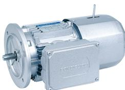
Los motores de la serie BN cumplen con todas las normas internacionales aplicables, incluidas Directivas la EMC y LV. Están disponibles para el rango de potencias de 0,06-30kW con patas o con brida tipo IM B5 e IM B14. Disponibles con una polaridad, o doble, con tres opciones de freno, alimentados a CA o CC, dando mayor flexibilidad al sistema. Por último, todos los motores pueden ser gobernados por variador de frecuencia.
