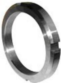
Las tuercas ranuradas se utilizan para fijar los rodamientos sobre el eje o sobre un manguito de montaje además sirven para montar o desmontar rodamientos en manguitos de desmontaje. Las tuercas ranuradas tienen cuatro u ocho ranuras repartidas uniformemente en la circunferencia en las cuales se aplica la llave de gancho.
