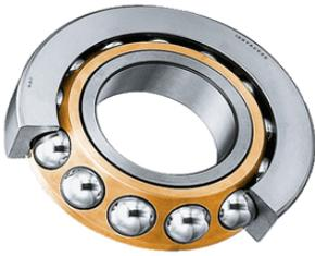
Los rodamientos a bolas de contacto angular, de una hilera, soportan elevadas fuerzas radiales y cargas axiales en un sentido. Para el guiado axial opuesto se requiere otro rodamiento, colocado simétricamente, en oposición.
