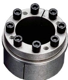
Los anillos de bloqueo RINGBLOCK, conocidos como Tollok, satisfacen tanto las ventajas de los sistemas de ajuste forzado (de apriete) así como la instalación y desmontaje simplificado. Se basa en el principio de cuña: la carga axial de los tornillos genera a través de las cuñas una elevada fuerza radial que bloquea las partes por fricción.
