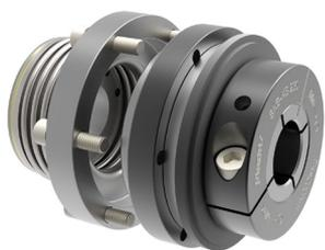
La serie SKB-KS es un acoplamiento de seguridad integrado con fuelle metálico. Se puede generar una capacidad de par de 2-3000 Nm. Su eje viene en dos diámetros diferentes. El D1 tiene un rango de diámetro de 6 a 70 mm, mientras que D2 tiene 2 a 100 mm de diámetro. Es capaz de compensar la falta de alineación.
