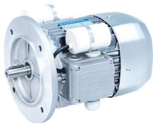
Los motores monofásicos de la serie BS son fabricados según normas IEC y son de tipo cerrado, ventilados externamente y con condensador de marcha permanentemente conectados. Los motores están disponibles en brida tipo B5 y B14 en la ejecución de 4 polos. Para aplicaciones que requieren alto par de arranque, se puede solicitar un condensador especial para el arranque y para el trabajo continuo.
