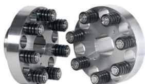
Acoplamiento elástico a la torsión con seguridad a rotura de pasador y casquillo. Puede montarse axialmente y se caracteriza por un diseño compacto. Además, permite desmontar fácilmente los elastómeros, incluidos los pasadores, sin desmontarlo.
