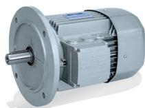
Los motores BE normalizados IEC cumplen con la norma IEC60034-30:2008 (clases de eficacia) y todas las normas internacionales aplicables, incluidas las Directivas EMC y LV. Están disponibles en el rango de potencias de entre 0,75 a 22kW con patas y con bridas tipo IM B5 e IM B14. Todos los motores pueden ser accionados por medio de variador de frecuencia.
