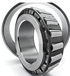
En los rodamientos de rodillos cónicos, los caminos de rodadura en los aros interior y exterior, y los rodillos son cónicos. Estos rodamientos han sido diseñados para soportar cargas combinadas, es decir, cargas que actúan de modo radial y axial simultáneamente.
