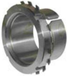
Los manguitos de montaje son diseñados para fijar rodamientos con agujero cónico sobre ejes cilíndricos. Para los ejes se admiten tolerancias de mecanizado más amplias que si el rodamiento estuviera montado directamente sobre el eje. Los manguitos de montaje se suministran conjuntamente con tuercas y elementos de seguridad. Bajo demanda se suministran manguitos de montaje en pulgadas y en milímetros. Para el montaje de grandes rodamientos se dispone de manguitos de montaje hidráulico.
