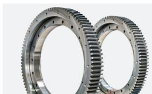
Debido a su construcción, soportan con gran seguridad cargas axiales, cargas radiales y momentos de vuelco en una sola rodadura. Por esta razón, las soluciones con combinaciones de rodamientos radiales y axiales, en muchas ocasiones se pueden reducir y simplificar a un solo punto de apoyo. De esta forma, se reducen notablemente los costes para la disposición de la construcción anexa y el esfuerzo de montaje de los rodamientos.
