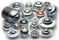
Las bolas de transporte son ampliamente utilizadas en todo tipo de industrias, con el fin de conseguir un movimiento en cualquier dirección de cualquier género por pesado que sea, con el menor esfuerzo. Están compuestas de una bola de precisión de gran tamaño que rueda encima de un gran número de bolas de diámetro pequeño, todas ellas dentro de una caja semiesférica de acero templado.
