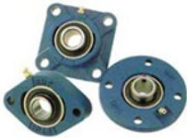
Los soportes de brida de fundición de hierro robusto con brida cuadrada y brida redonda constan de una base con cuatro agujeros para los pernos de montaje. Los soportes ovalados se suministran sólo con dos perforaciones. El asiento esférico de los rodamientos insertos permite el desalineamiento en el montaje inicial. Se dispone de soporte con rodamientos para ejes milimétricos y en pulgadas.
