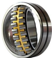
Los rodamientos de rodillos a rótula son rodamientos destinados a aplicaciones extremadamente severas, principalmente en industrias pesadas tipo siderurgia, papeleras, canteras... Tienen que poder resistir cargas elevadas, desalineamientos importantes, ambientes polucionados, golpes, vibraciones. Estas condiciones requieren cualidades mecánicas excepcionales.
